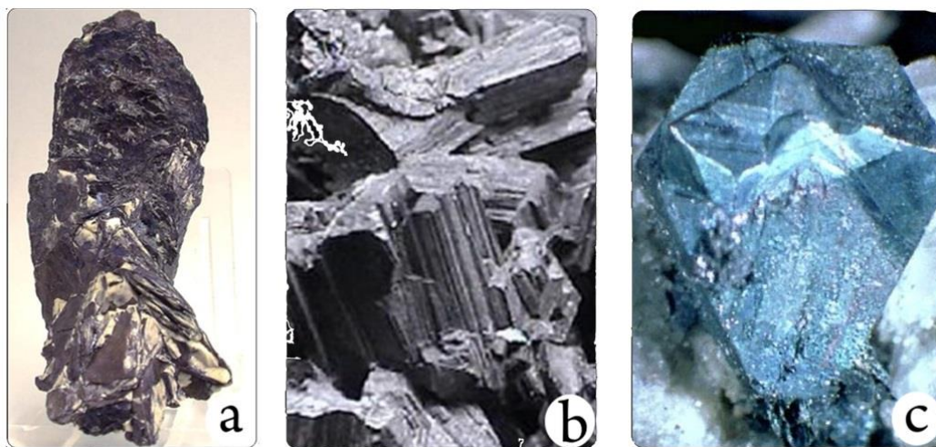
Figura 1.5: Imagens dos minerais: (a) covelita – \text{CuS} , (b) Calcocita – \text{Cu}_2\text{S} e (c) Bornita – \text{Cu}_5\text{FeS}_4 . Figuras retiradas das referências [39], [40] e [41] , respectivamente.
